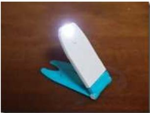
まず1.の光源、これはLEDのクリップライトを改造。写真の青色の部分ねじり取り、電池や回路・LEDが仕込まれている白色部分だけにする。
