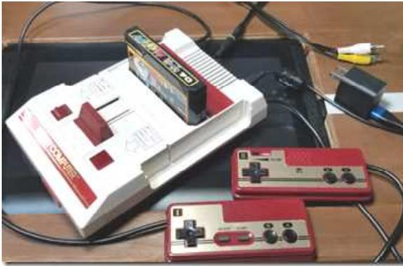
購入したのは、ヤフオクの出品されていた古いファミコンをリストアしたものの。それなりの需要はあるようで、複数の出品者が出品している。単に外装を漂白するだけではなくて、安定化回路を組み込んでいたり、電源はUSB化されていたり、映像出力はコンポジットに、音声出力はステレオにするなど、今の環境で使えるようにリストアされているブツである。
