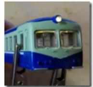
まずダミーの前照灯部分に1.8mmピンバイスで穴を開けておく。
