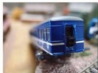
電池ボックスは単5用のものだが、車両本体の窓と干渉するので、側面は大きく削ってある。
