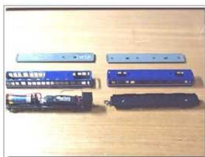
左が電池とユニットとカメラを組み込んだ車両
